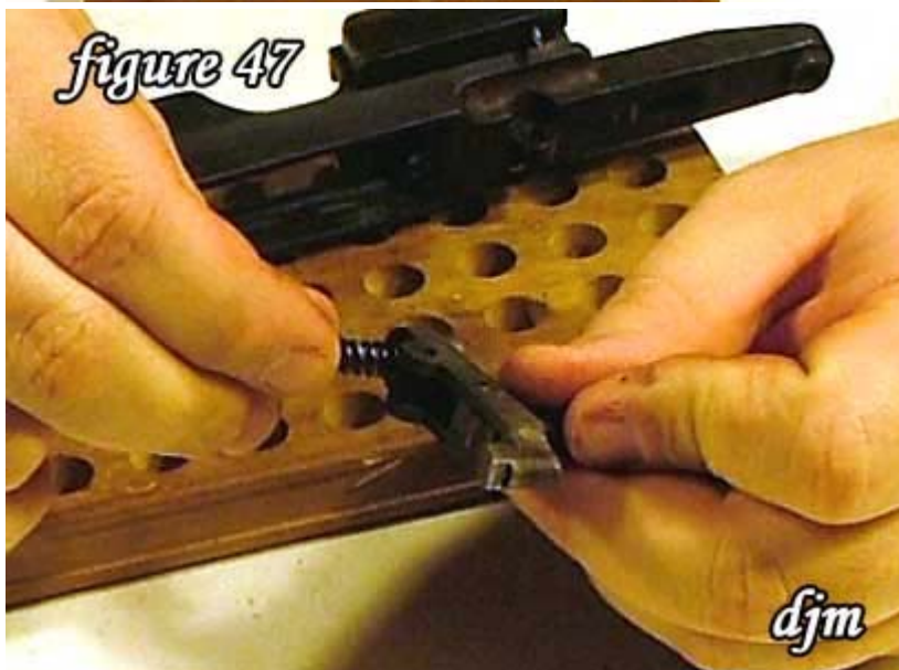
47) Install the sear spring.
