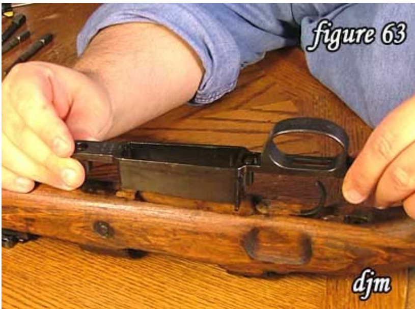
63) Replace the trigger guard.
