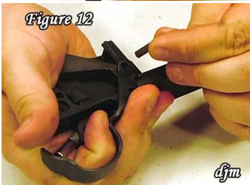
12) Remove the hammer pin.
