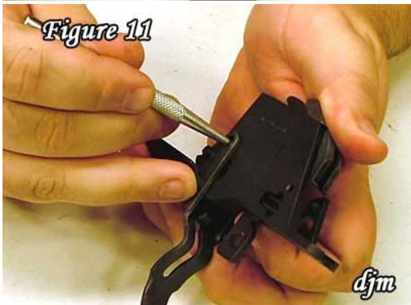
11) Drift out the hammer pin.
