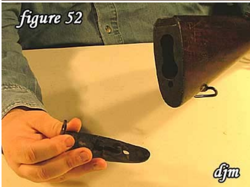
52) Replace the butt plate.
