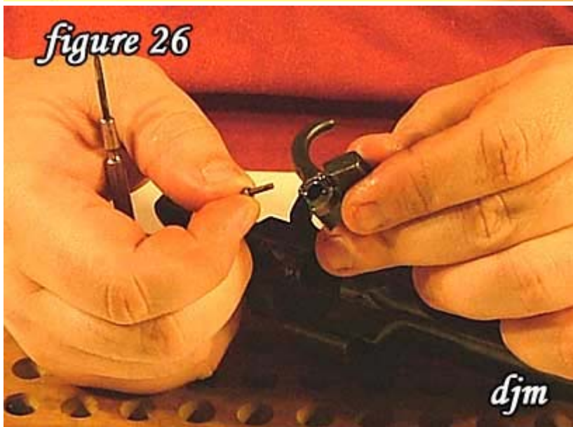
26) Remove the plunger.
