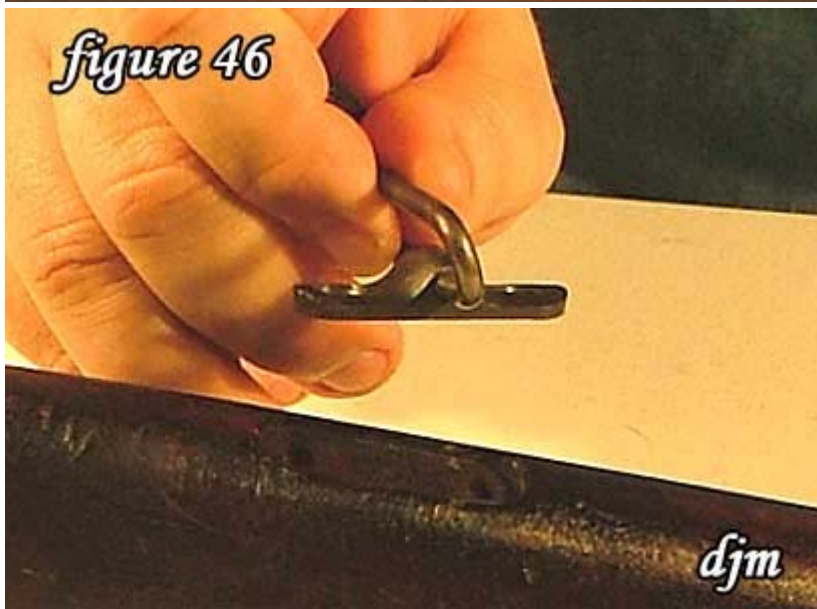
46) Remove the rear swivel.
