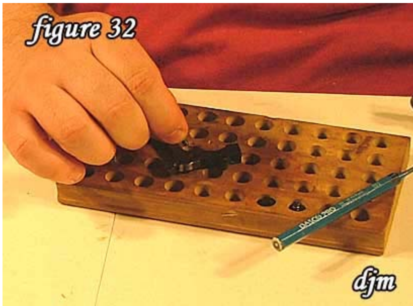
32) Remove the trigger pin.
