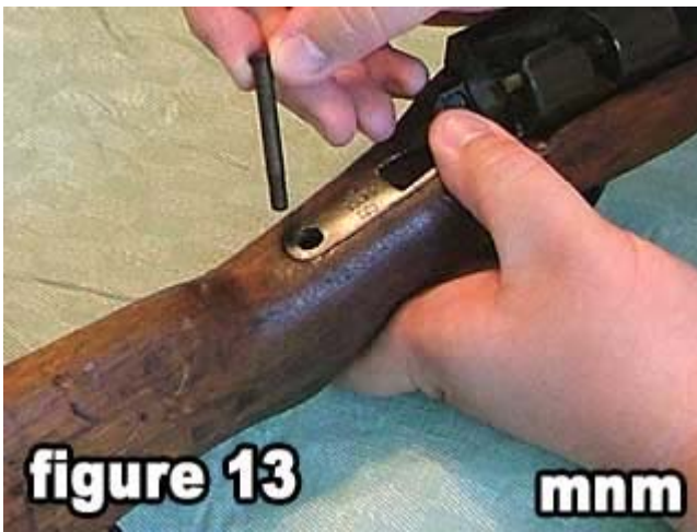
13) Remove the tang screw .
