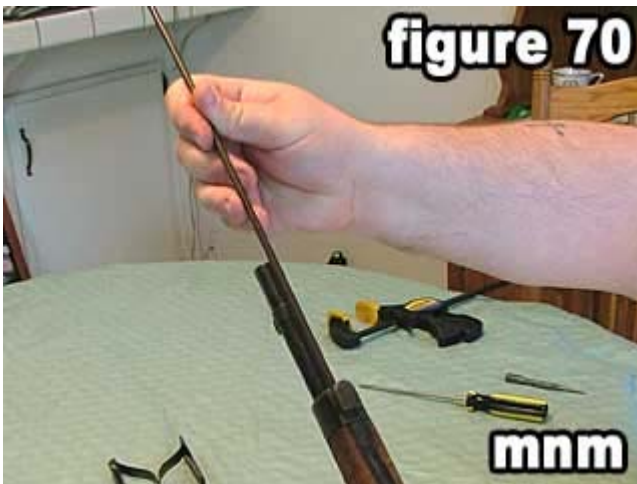
70) Insert cleaning rod .
