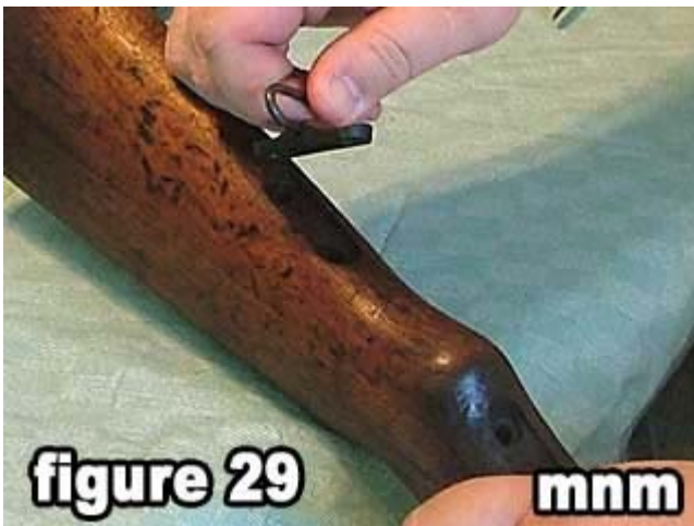
29) Remove the rear sling swivel .
